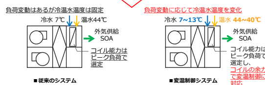
熱源・空調を連携した冷温水変温制御
