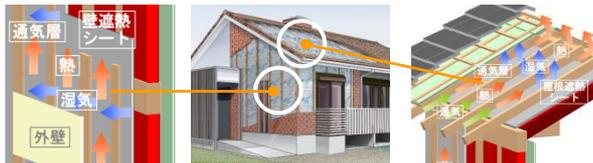
冷たい外気を反射し暖房の輻射熱を室内に戻すことで体感温度を上昇させる。
