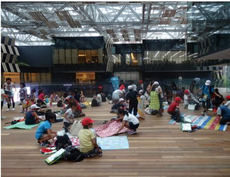
地域の気候風土に対応して外に閉じつつ内に開く市民活動空間「ナカドマ」を設置。これが、気温差の緩衝空間となっている。また、太陽光発電を設置した千鳥格子の屋根などにより日射や風をコントロール。
