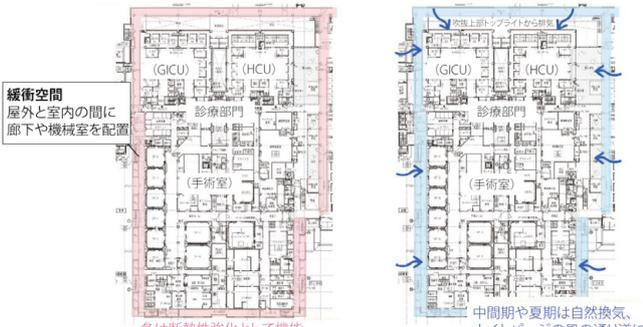
緩衝空間が、冬期は室内への外気による影響を抑える「断熱効果」として、夏期は「自然換気」「ナイトパーズ」により風の通り道として機能する。
