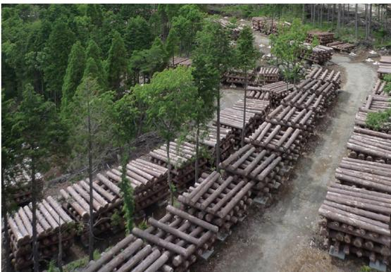
輪掛け天然乾燥材を横架材に使用することで、0.5t/戸のCO<sub>2</sub>削減。
