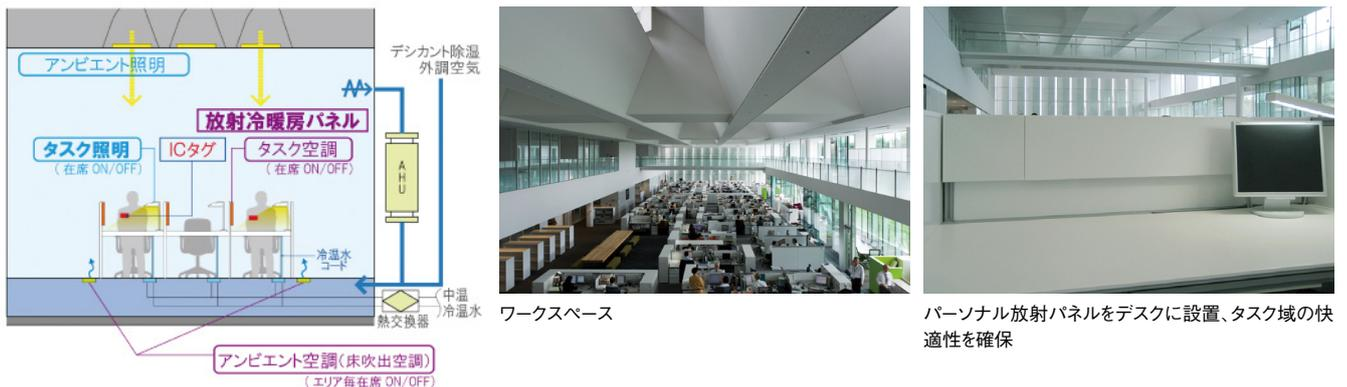
ICタグにより不在の席を検知し、タスク照明、パーソナル空調を制御
