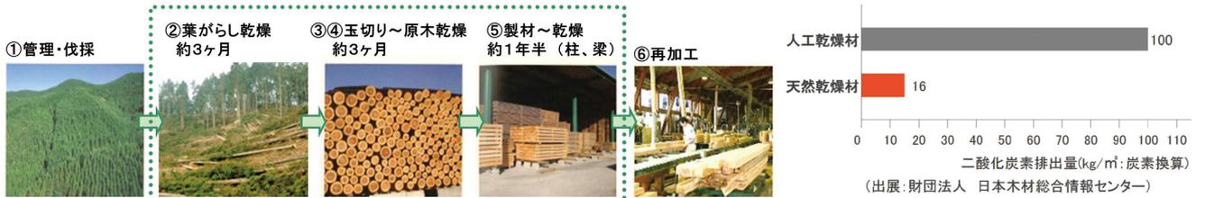
天然乾燥(約2年間)による構造材・羽柄材の生産と天然乾燥によるCO<sub>2</sub>削減量
