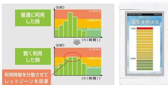
**MEMO** 電力一括受電を採用することで、独自の省エネ推進型料金制度として、使用電力に応じた3段階の電力単価を設定しています。また、電力の料金プランとマッチしたリアルタイムでのデマンドインジケータなどで電力使用の状況を見える化し、居住者自らが自宅の電力使用パターンを理解し、電力ピークの抑制と省エネを進めることができるよう工夫されています。
