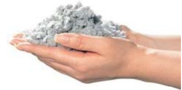
壁断熱材 : セルロースファイバー
