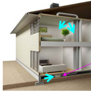
床下へ2階用 涼換気ファン本体設置
