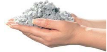
壁断熱材 : セルロースファイバー
