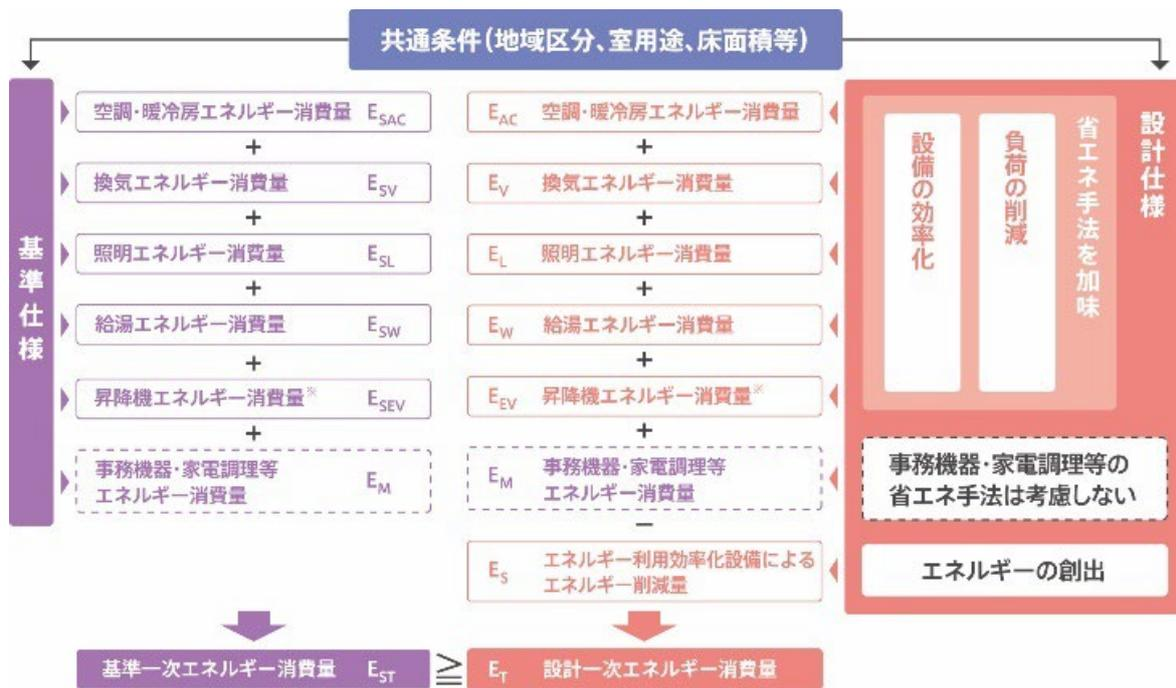
図1 一次エネルギー消費量による評価の枠組み (注：住宅の場合、昇降機のエネルギー消費量は対象外)
