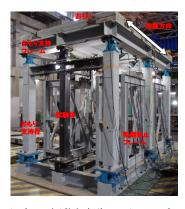
写真 5 振動台実験セットアップ
