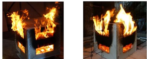
写真2 スケール比較実験の様子(左1/10:右1/20)
