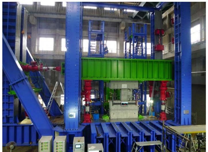
実大鉄筋コンクリート造柱の加力実験
