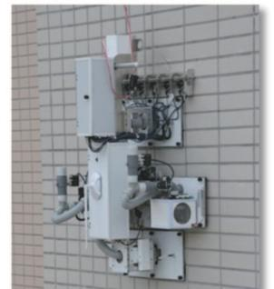
図1 自走式外壁診断装置
