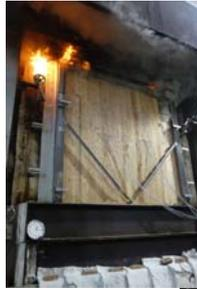
壁の荷重加熱試験
