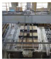
床・屋根の荷重加熱試験
