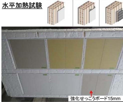
せっこうボード12.5mmと15mm、強化せっこうボード12.5mmと15mm、ケイ酸カルシウム板(0.8FK)12mm、金属サイディング、窯業系サイディング16mm
