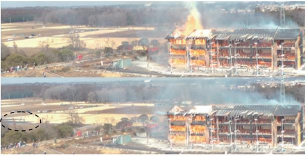
図6 周辺への飛火（点線内で芝の焦げ。上下時間差4分）
