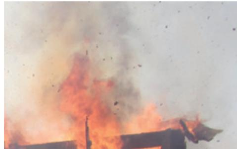
図2 屋根燃え抜けに伴い発生する火の粉
