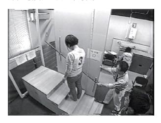
写真 4 階段手摺高さの検証
