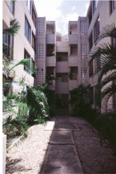
写真 7 平良市宮馬場団地の住棟に挟まれた中庭。夏至の日の南中高度 88.9° という強烈な日射をさけるための工夫。この中庭には珊瑚の砂利が敷かれている。
