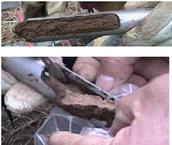
写真-5 試料土の採取装置の例
