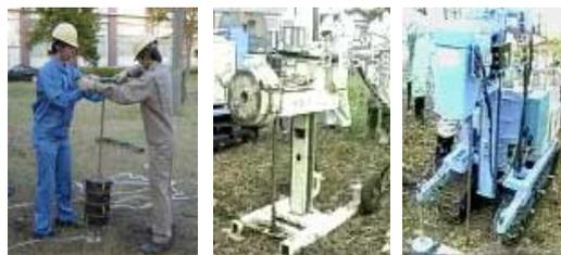
写真-1 SWS 試験(左より、手動式、自動式、自動式)
