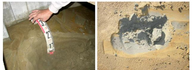
写真-6 見附市における液状化による噴射の例
