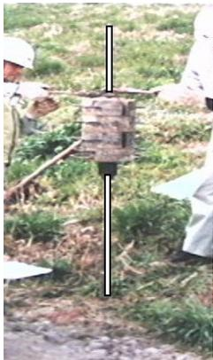
写真-3 自沈層に対して不適切な測定方法
