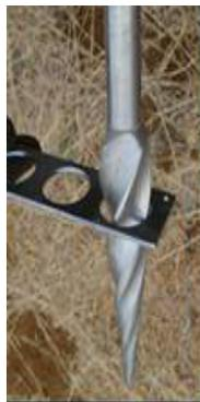
写真-4 スクリューの寸法検査の例
