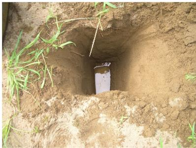
写真-26 液状化被災地での浅い地下水位
