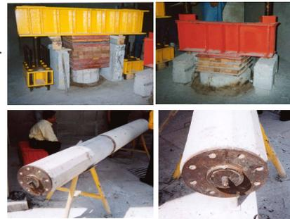
写真-18 八角形の既製コンクリート杭（平出務氏提供）
