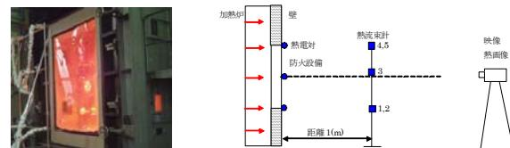
図 2 開口部からの放射熱の測定実験
