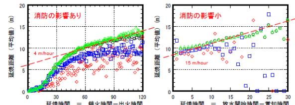
図 4 過去の市街地火災における延焼速度の分析結果
