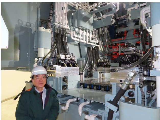
遠心載荷装置の振動台（水平・上下2方向加力）
