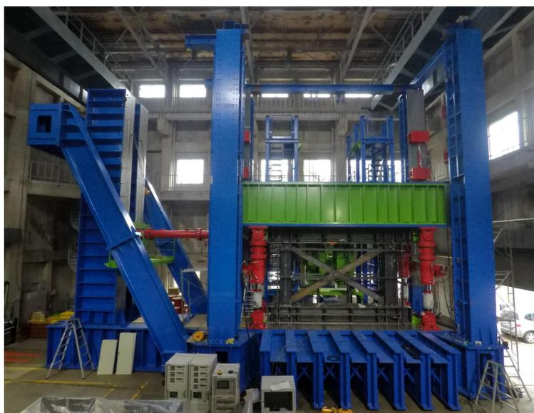
試験装置正面（面内水平 1 台，鉛直 4 台）
