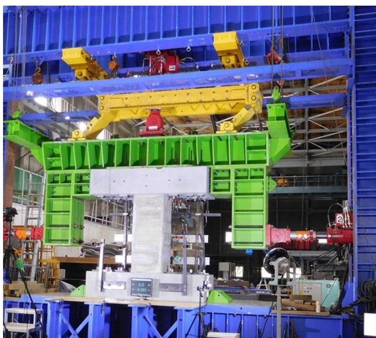
柱の逆対称載荷実験
