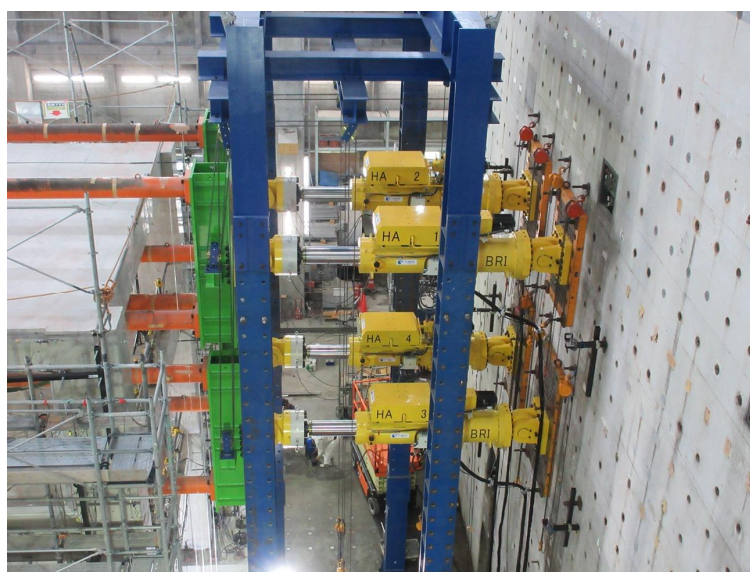
ハイブリッドアクチュエータを用いた載荷実験（4台を同時に制御）
