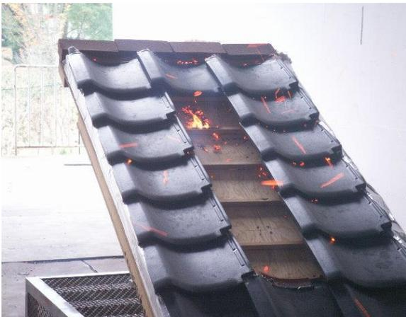
火の粉による屋根への着火実験
