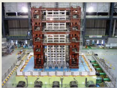
縮小20層建物試験体の震動実験(RC造)
