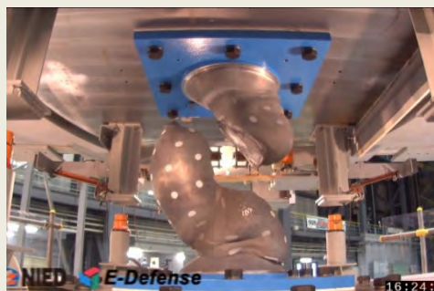
鉛ダンパーの二方向加振実験 (破断後の様子)
