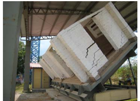
アドベ造建物の 傾斜実験の様子
