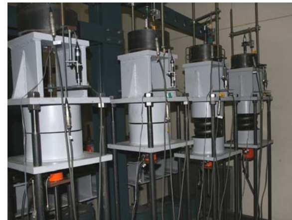
載荷装置・載荷状況
