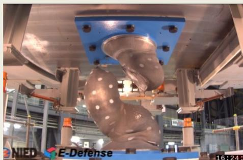
鉛ダンパーの二方向加振実験
