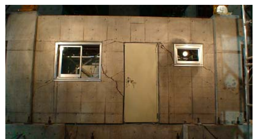
図2 各種データベースの構築例 (RC 外壁の場合) と実大実験の様子
