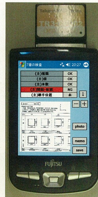
図4 検査に使用する PDA。検査支援情報 が表示される。 また、音声入力等 によって検査結果 を記録することも できる。
