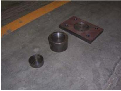
写真5, ②石材の設置治具 (写真では, ステンレスの試験体を示す)
