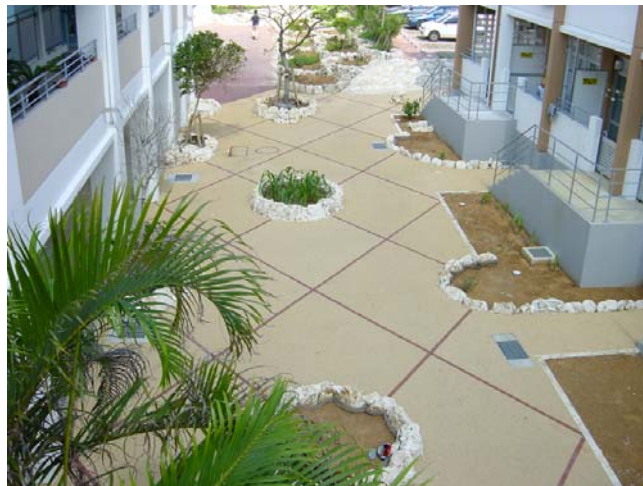
写真 6 沖縄県営平良団地中庭 (珊瑚の堆積物からできた地元産の琉球石灰岩を使用)
