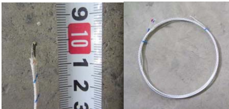
写真1 熱節点の処理状況
