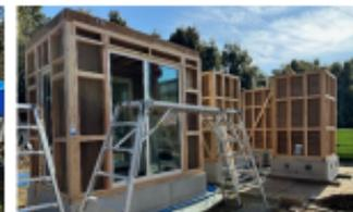
建具試験体と基礎貫通配管試験体
