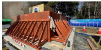
止水性検証水槽と外壁試験体
