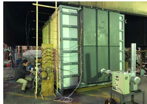
図 6 不燃扉の漏煙量測定装置による実測
