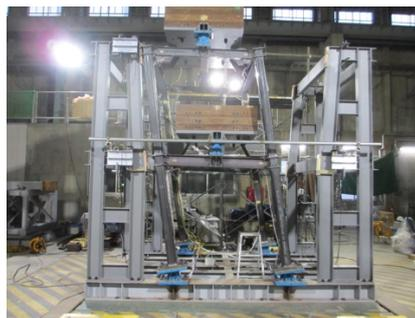
写真1 2層骨組の振動台実験（加振後）
