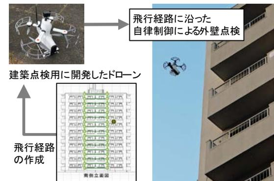
図2 非GPS環境下でのドローンによる外壁点検の事例
