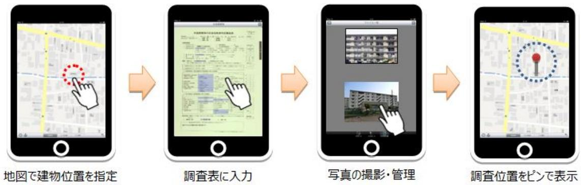
図-I-1. 2. 12 応急危険度判定支援ツールの入力・表示のイメージ
