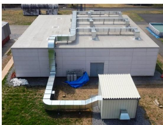
写真2. 排煙の効果を検証する実大煙実験装置
