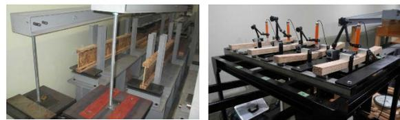
図 1 I 型ジョイスト（左）とそのフランジ（LVL）のクリープ破壊試験
