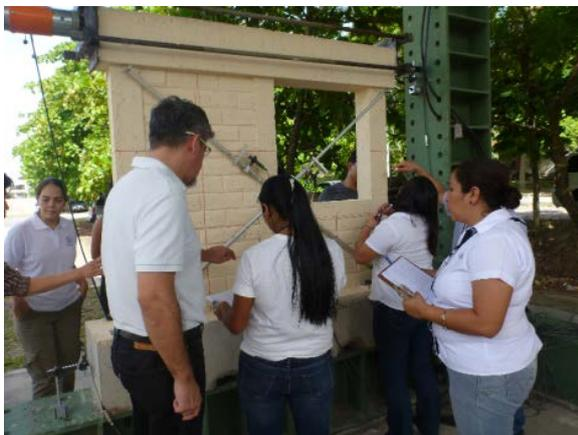
写真-I-2. 1. 12 枠組組積造壁の水平載荷実験の様子（国立エルサルバドル大学）
