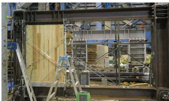
図 5 S 造フレーム CLT 耐震壁の構造実験
