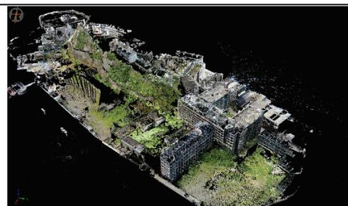
図 3 点群データの収集(端島住棟群)
