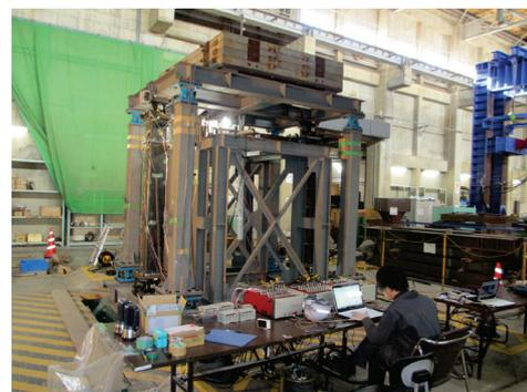
写真 2 1 層 1 スパン骨組の振動台実験
