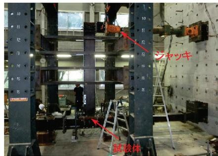
写真1 梁端部の多数回繰り返し荷重実験
