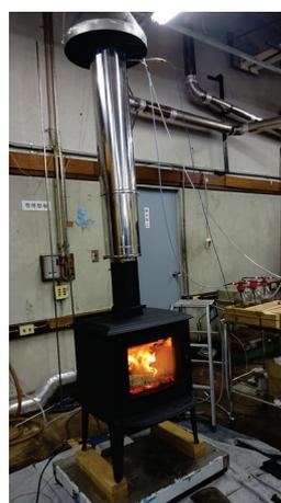
写真 2 薪ストーブの効率測定
