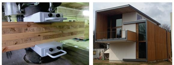
図6 異等級構成 CLT のめり込み試験(左)と実大実験棟(右)
