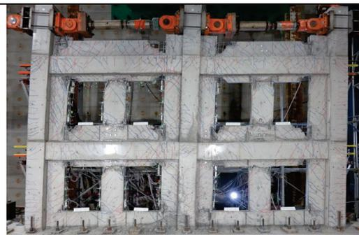
写真 2 UFC パネルを用いた耐震改修実験
