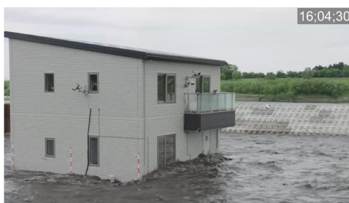
十勝川千代田実験水路を活用した 実大木造住宅の水理実験
