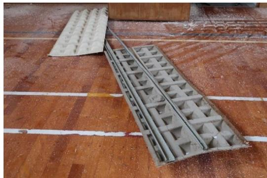
写真 NA-105.10 脱落した凹凸のある繊維系の部材
