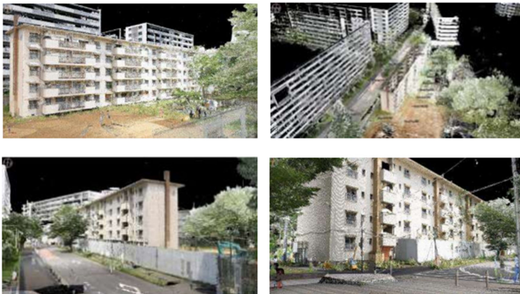
図 A6.1 計測位置（上図）と計測結果より得られた3次元カラー点群（下図）
