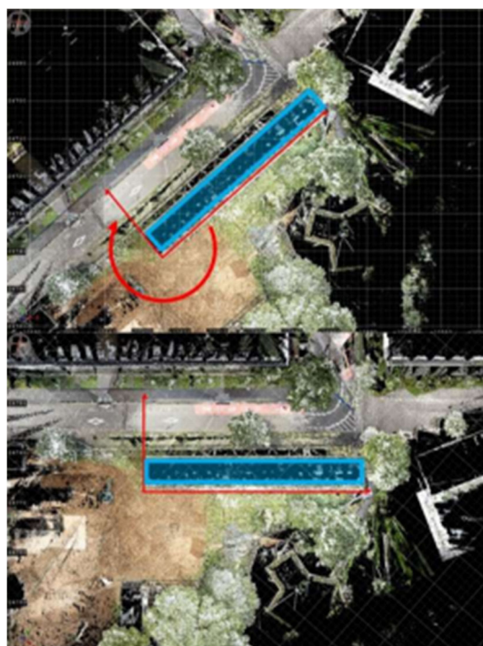
図 2.15 部位の局所座標への変換
