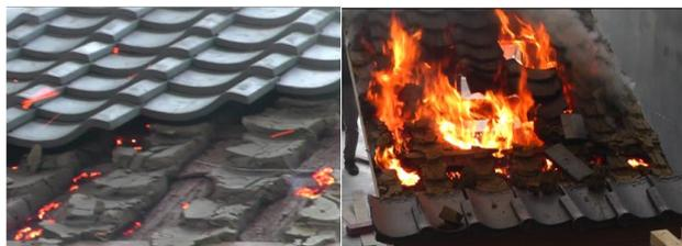
写真2 再現実験:火の粉の着床と飛び火による炎上
