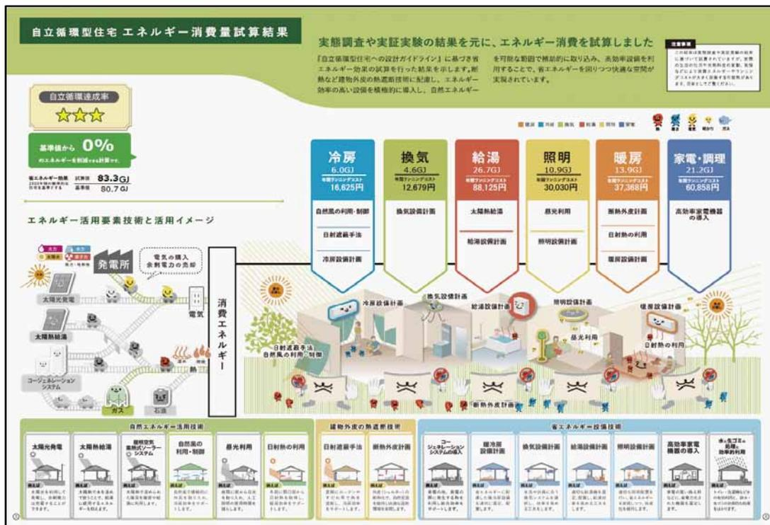
■ 図7 自立循環型住宅への省エネルギー効果の推計プログラム(計算結果のみ掲載)
