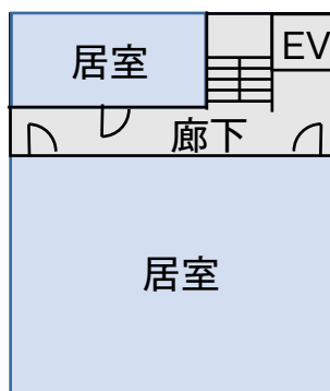
■写真1 階段が竪穴区画されていない例 (階段室の踊り場が廊下の一部となっており、階段を防火区画することが困難)
