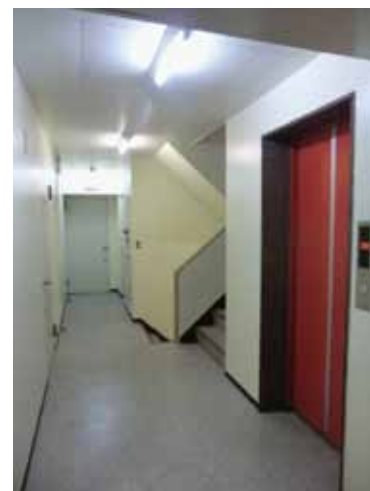
■写真1 階段が竪穴区画されていない例 (階段室の踊り場が廊下の一部となっており、階段を防火区画することが困難)
