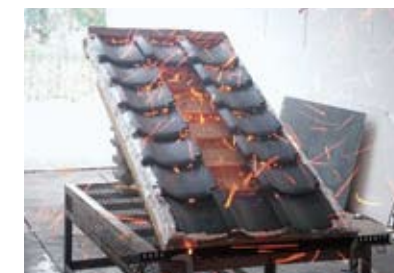
■写真7 飛び火の発生を調べる実験
