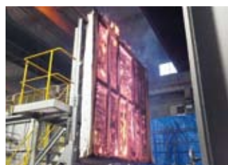
■写真3 加熱試験直後のCLTパネル試験体
