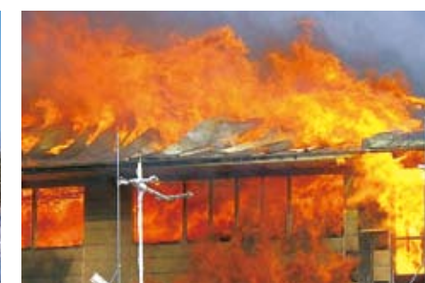
■写真6 屋根が燃抜けて火の粉を噴出(44分後)
