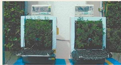
緑化パネル試験体を用いた壁面緑化の効果測定
