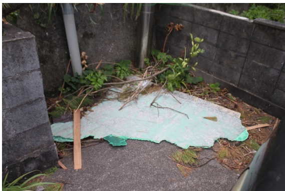
写真-8.5.1.16 飛散した元造船所倉庫 の FRP 外装材
