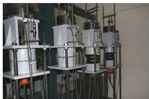
写真1 引張クリープ試験の状況
