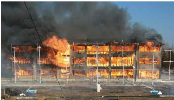
写真3 3層が同時に燃焼 (33分後)
