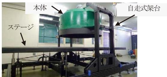
写真35 竜巻状気流発生装置の概観
