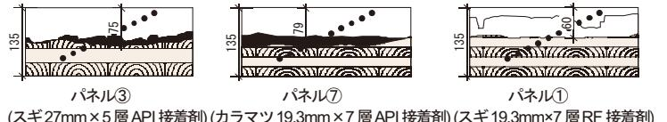
図3 CLT一般部炭化図(90分加熱)
