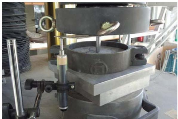
写真3 押し抜き試験の実施状況
