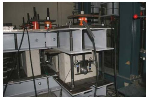
写真2 せん断クリープ試験の状況
