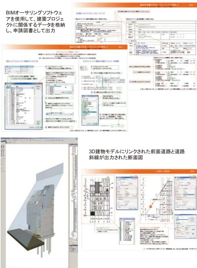
図-15 BIM ソフトウェアにおける設計情報格納手法の例<sup>9)</sup>
