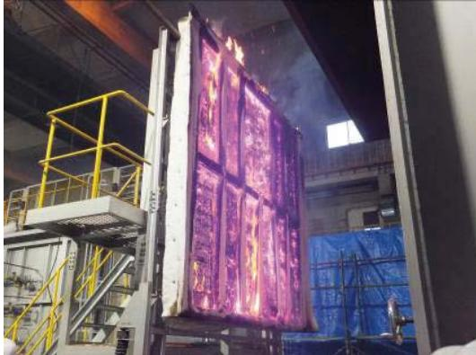
写真1 加熱試験直後のCLTパネル
