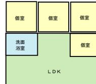
2-2.リビングを配する主たる方位以外に個室が4室(外気に面する面に3室、内側に1室)水周りが中央部。片廊下型に見られるN=11
