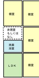
2-2.リビングを配する主たる方位に個室が1室、主たる方位以外に個室が3室(外気に面する面に2室、内側に1室)水周りが中央部。片廊下型に見られるN=27
