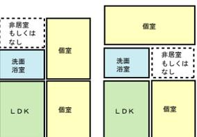
1. リビングを配する主たる方位に個室が1室、主たる方位以外に外気に接する個室が1室。片廊下型に多く見られる N=38
