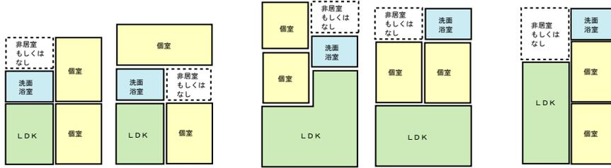
1. リビングを配する主たる方位に個室が1室、主たる方位以外に外気に接する個室が1室。片廊下型、センターコア型に見られる N=34
