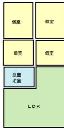
1. リビングを配する主たる方位以外に個室が4室(外気に面する面に2室、内側に2室)水周りが中央部。片廊下型に見られる N=40
