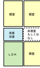
3-3. リビングを配する主たる方位に個室が1室、主たる方位以外の外気に面する面に個室が2室。水周りが中央部。片廊下型に見られる N=8
