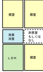
1. リビングを配する主たる方位に個室が1室、主たる方位以外の外気に面する面に個室が2室、水周りが中央部。片廊下型に見られる N=7
