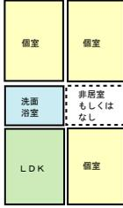
1. リビングを配する主たる方位に個室が1室、主たる方位以外の外気に面する面に個室が2室、水周りが中央部。片廊下型に見られる N=5
