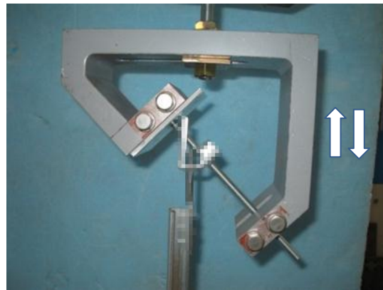
図3.4.3 斜め部材の上端接合部の試験体の取り付け状況の例 (矢印は加力方向を表す。吊りボルトの右下端は自由端としている。)
