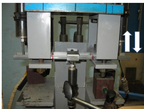
図 3. 3. 3 ハンガーを含む接合部の試験体の取り付け状況の例 (野縁方向に加力する場合、矢印は加力方向)
