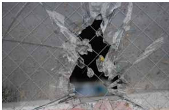
写真 3.4-36 ガラスへの飛来物の衝突痕
