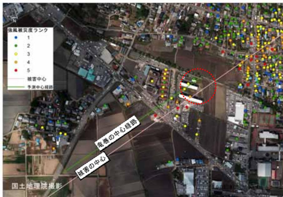
図 2.3-14 被害中心線と竜巻の中心経路（北条地区）
