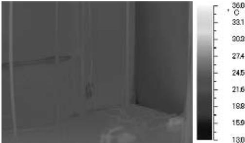
図 24 改修前(和室西戸境壁入り隅)(改修前:室内  $24.5^{\circ}\text{C}$ 、外気  $1.5^{\circ}\text{C}$ )
