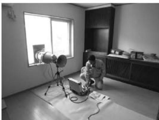
図 12 気密性能測定の様子
