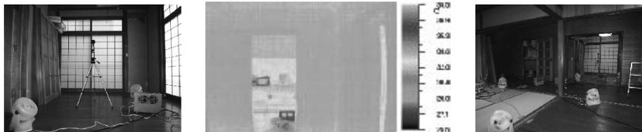
写真 2 1階廊下間仕切壁表面温度分布(改修前:室内 20.3°C、外気 7.8°C、改修後:室内 32.3°C、外気 9.3°C)
