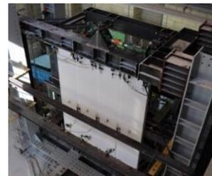
図10 ALC間仕切り壁の面外・面内実験
