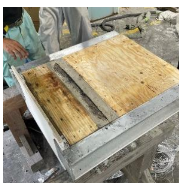
写真4 水切り金物の変状・合板の炭化なし(1時間加熱後)
