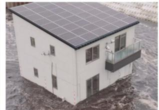
写真2 実大住宅の水理実験(十勝川千代田実験水路)
