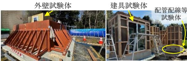
写真3 外壁, 建具, 基礎貫通配管配線等の止水性能検証実験
