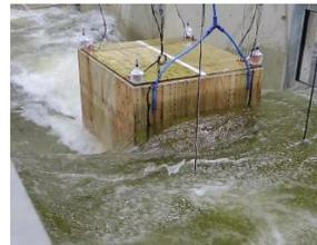
写真1 縮小住宅模型の水理実験(津波・氾濫水路)
